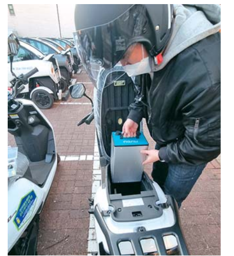
경주 황리단길 전기이륜차 배터리 공유 스테이션에서 전기 바이크 이용자가 직접 배터리를 교환하고 있는 모습
